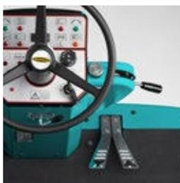
Xtrema monta un potente sistema di trazione, a velocità variabile fino a 9 Km/h, governato per mezzo di bi-pedaliera (marcia avanti e indietro).
