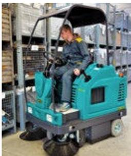
Per il massimo comfort e la massima sicurezza di guida, Xtrema è disponibile con numerosi accessori: Faneleria completa / Cicalina acustica per la retromarcia / Tettuccio di protezione / Parabrezza in policarbonato / Lampeggianti (standard nei paesi CE) / Filtro a sacche classe M
