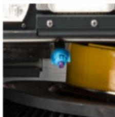
Le spazzole laterali di BULL 200 possono essere dotate di nebulizzatori per abbattere le polveri.
