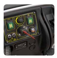
Leva di comando per azionamento spazzola ed erogazione soluzione detergente. Chiave per accensione/ spegnimento ed esclusione batteria, interruttore motore spazzole e motore aspirazione, manopola per dosare detergente (optional), disgiuntore termico per proteggere il motore spazzole e aspirazione, indicatore livello batteria, contaore (optional).
